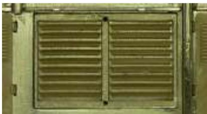
Für die seitlichen Lüftergitter werden zunächst auf jeder Seite das Teil 31 in die seitlichen Vertiefung gelegt und festgeklebt. Darauf wird wahlweise Teil 32 oder 33 mit Nadeln in den Bohrungen fixiert und vorsichtig an den Seiten verklebt. Bei Teil 32 können die Lamellen noch leicht nach außen justiert werden.
