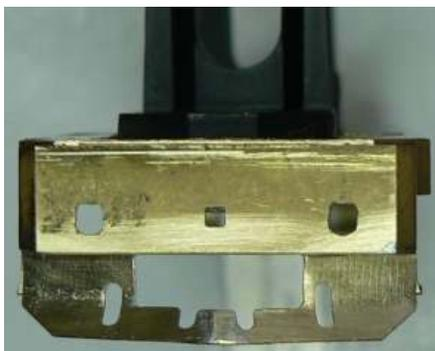
Je nach Ausführung hat die Lok verschiedene Puffer. Für meine Variante habe ich Rechteckpuffer aus Kunststoff verwendet. Die Puffer werden durch die Puffergrundplatten (49) und in die Bohrungen der Pufferbohle gesteckt und dann von innen verklebt. **Achtung:** Bei Verwendung des 110er Fahrwerkes müssen die Puffer etwas höher positioniert werden, um die korrekte Pufferhöhe zu erreichen. Dazu sind die vorhandenen Löcher entsprechend nach oben auszufeilen.
