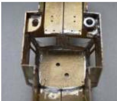
Im Führerhaus werden auf der hinteren Außenseite (kurzer Vorbau) kleine Winkel aus Messing (z.B. vom Rest des Drehgestellrahmens) mit einer Mutter M2 eingelötet.
