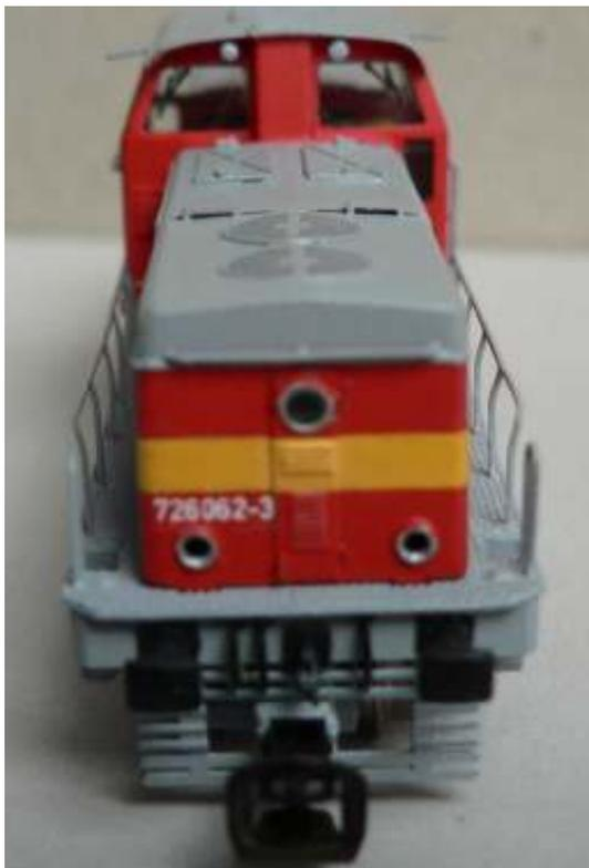
Für das Führerhaus werden Fensterscheiben aus Klarsichtfolie ausgeschnitten und von innen angeklebt. An den Seitenfenstern wird auf der Innenseite mittig eine senkrechte Linie eingeritzt und mit dünnem schwarzen Permanentmarker nachgezogen, um das Schiebefenster anzudeuten.
