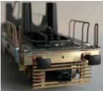
Die Schienenräumer (51,52) werden an den Frontseiten festgeklebt. Am Bauteil 52 werden vor dem Einkleben die drei unteren Leisten im Mittelteil ausgeschnitten, um den nötigen Platz für NEM-Schacht und Kupplung frei zu machen. Die Griffstangen (54) für die Leitern und die Geländer (55) entsprechend der Zeichnung in die Bohrungen der Grundplatte stecken und verkleben.
